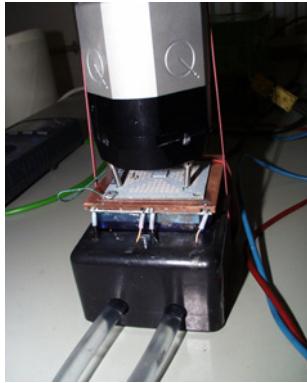
Bild 3: Messaufbau mit einem LFBGA-49 auf einer Heiz-Kühlplatte unter einem ESPI-Sensor
